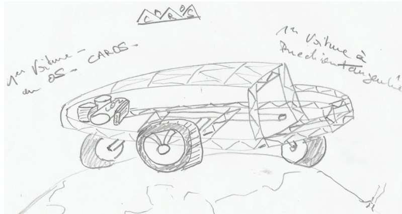
Structure allégée par triangulation
